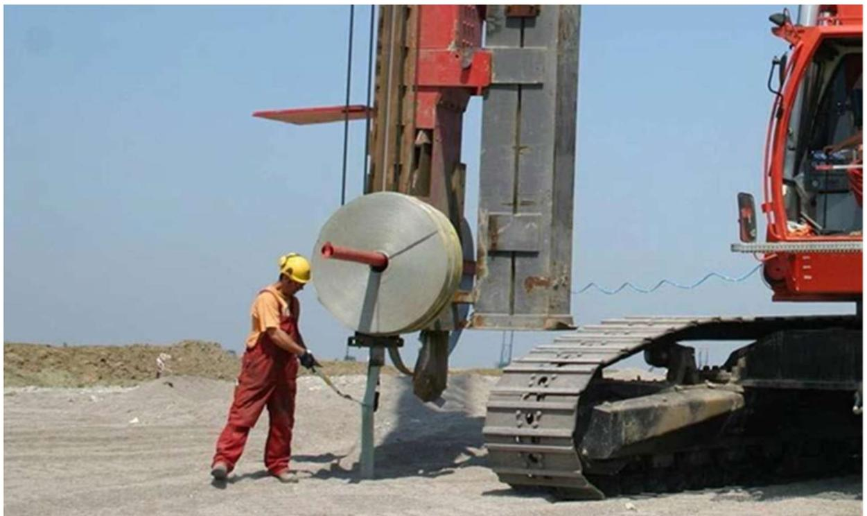
**Рисунок 8 - Экскаватор Komatsu PC600LC-6 С навесным оборудованием «Стичер» (устройство вдавливания)**
